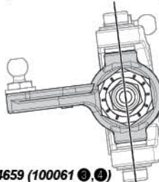
104659 (100061) ③, ④ Inline Steering Block Lenkhebel ohne Nachlaufversatz French インラインステアリングブロック
