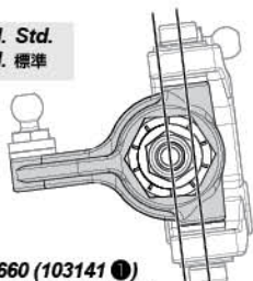
104660 (103141) ① Trailing Steering Block Lenkhebel mit Nachlaufversatz Lenkungsblock トレーリングステアリングブロック
